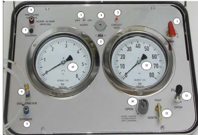
شكل (۴-۵): نماى كلي دستگاهى آزمون دایلاتومتري (Report of TC16, 2001)
