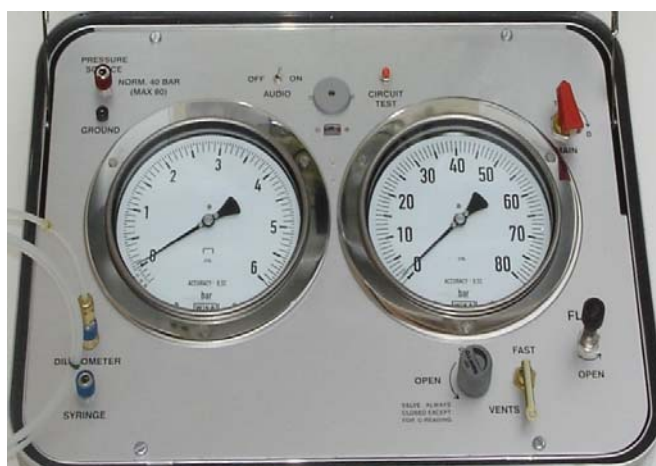
شکل (۳-۱۳): واحد کنترل دایلاتومتر (Report of TC16, 2001)
