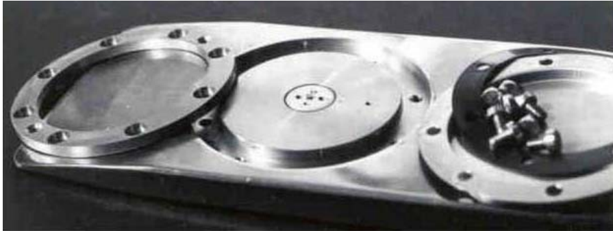
شکل (۳-۶): غشاء فیزی دایلاتومتر و تجهیزات مربوط به آن (Marchetti & Monaco, 2001)
