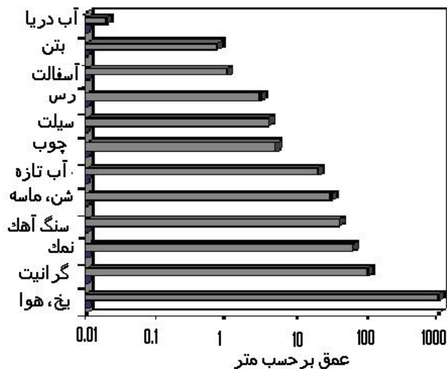
شکل (۸-۱۲) عمق نفوذ پیمایش به روش رادار نفوذی برای مصالح مختلف
