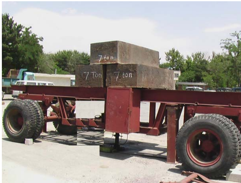
شکل (۵-۶): بارگذاری ۲۱ تنی توسط وزنه های فلزی (نمونه ی انجام شده در ایران)
