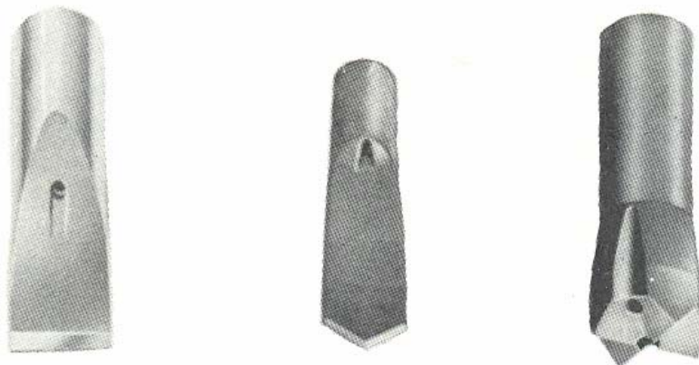
شکل (۳-۱۰): انواع سرمت در حفاری شستشویی (از چپ به راست: تخت، اسکنه ای و ضربدری)
